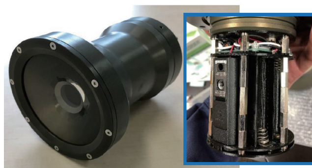
図 1. 小型軽量深海カメラシステム (左上) アルミ製耐圧容器 (7000m 耐圧)、 (右上) 内部機構、(下) 光源 LED
