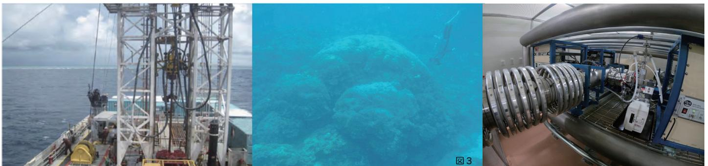
図 3：海水準を正確に記録するサンゴ礁資料。オーストラリアグレートバリアリーフの海面下 120m ほどまで掘削し、LGM のサンプル採取している様子（左）と、海面下 5 m ほどに生息する現在のサンゴ（中）と、図 1 の実際の観測データの復元に使用された大気海洋研究所に設置され、世界最高の分析精度を誇る、日本唯一のシングルステージ加速器質量分析装置。写真は 24 万ボルトになる加速デッキ部（右）。
