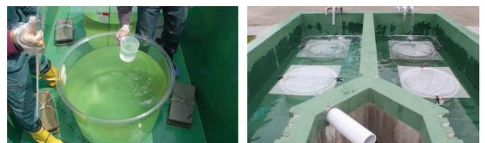
図2. メソコズム実験：200Lタンク4基を屋外水槽に入れて温度を一定に保つ (右) 数日後に植物プランクトンが大増殖し緑色に変化したタンク内の海水 (左)
