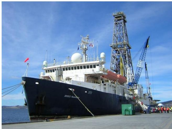
北太平洋や南大西洋で科学海洋掘削を行った米国の掘削船 JOIDES Resolution 号
