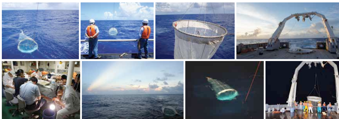
プランクトンネット（ORI-Big Fish：直径3m、目合0.5mm）による採集風景
