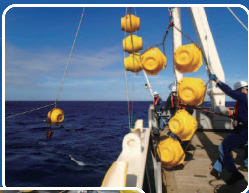
写真上：係留系の回収先端に流速計が取り付けられています
