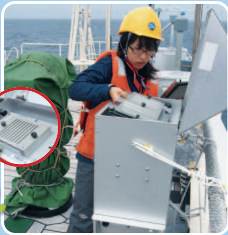
写真上：エアロゾルサンプラー 掃除機のように空気を吸引してフィルター上に粒子を採取します
