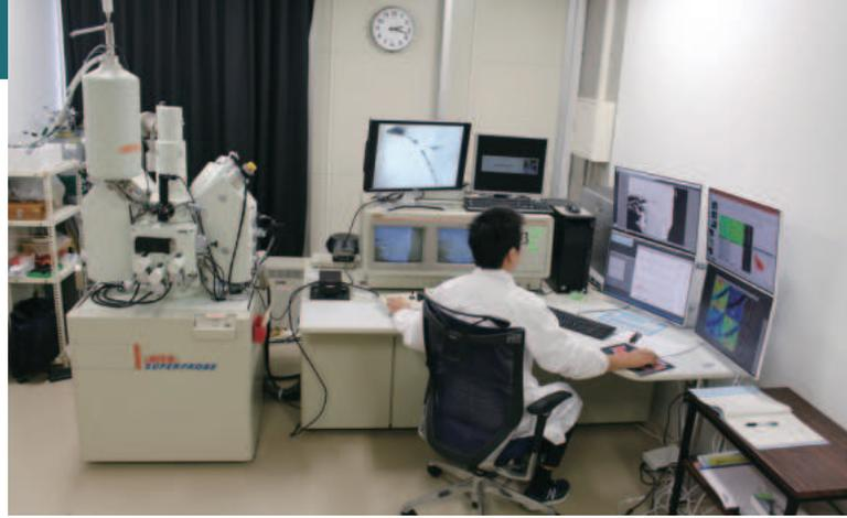
電子線プローブマイクロアナライザを使用して試料中の化学組成を分析
