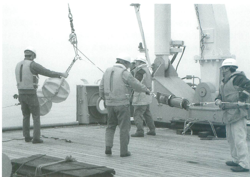
写真3：音響式流速計、アーンデラ社 RCM11、の設置(KH-07-1次航海レグ2)。
