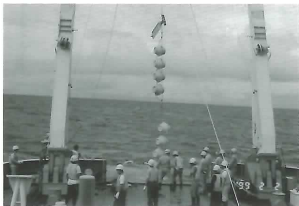
写真2. 係留系の設置作業。ガラス玉9個を付けた流速計を海に投入しているところ
