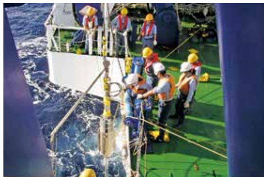
海洋調査船上でのピストン・コア投入作業
