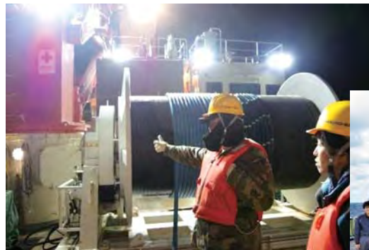
夜半に及んだストリーマケーブルの投入作業
