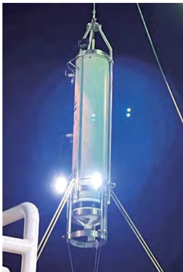
凝集体を捕集する装置であるマリンスノーキャッチャーの投入風景。マリンスノーキャッチャーには、大型凝集体観測のためのカメラシステムとLED光源を搭載している
