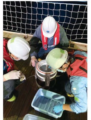
マリンスノーキャッチャーの底部に沈殿した沈降粒子の回収
