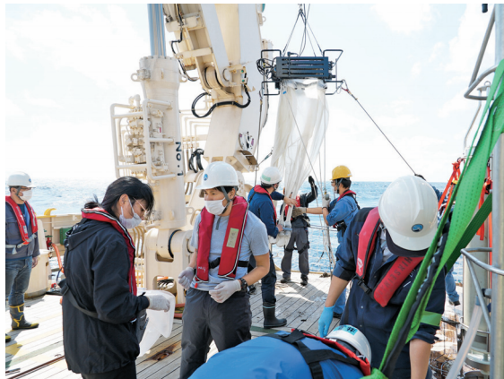
鉛直多層式-開閉ネットによる動物プランクトンの採取とマリンスノーキャッチャー内に漂う懸濁粒子の採取
