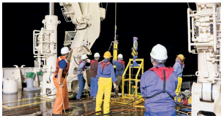
高解像度水温計付き電磁流速計フロートの投入の様子
