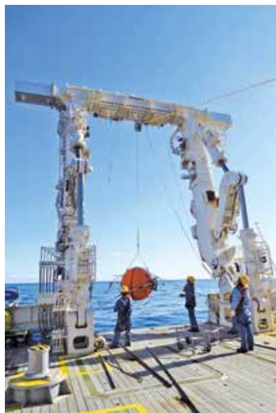
水深400mでの計測を終えて浮上し、 回収される係留系 (音響ドップラー流速計とパイ)
