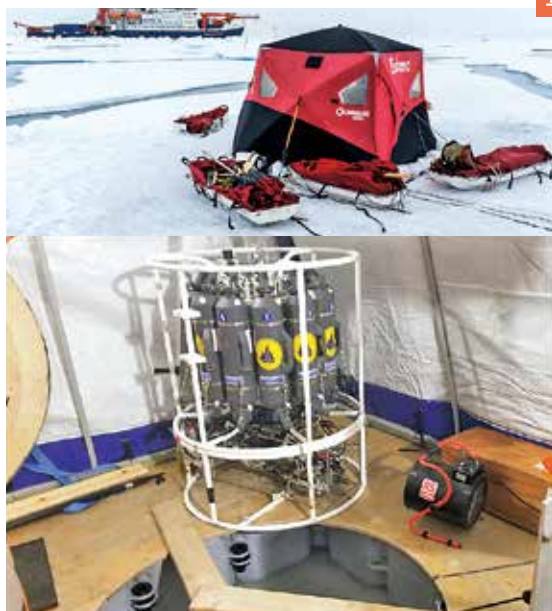
写真2 Ocean City(上)とテント内の12本掛けCTDシステム。船から電力が供給され、ウインチを用いてCTDを巻き上げる。
