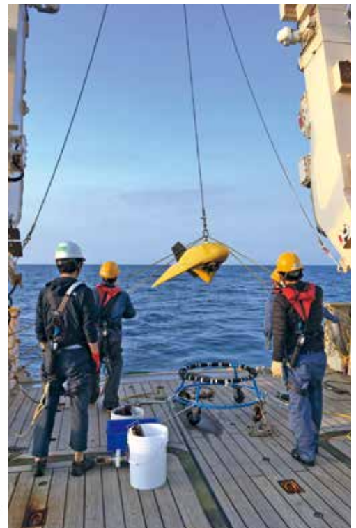
UTA曳航観測を終えて水中曳航体V-finを船上に揚収
