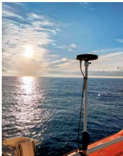
GNSSアンテナ
