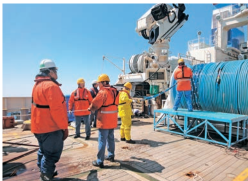
全長2000mのハイドロフォンケーブルを投入しています(KS-19-5次航海)
