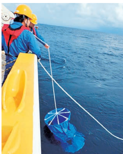
渦の流れを追跡する漂流ブイの投下シーン。青い部分はドロップと呼ばれ、抵抗体として設置した水深の流動を掴む
