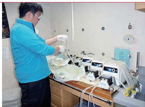
写真3 海水を同時に多数ろ過するシステム
