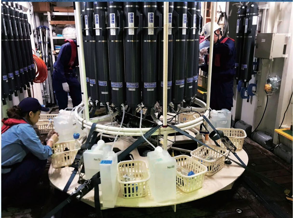
写真1、2 ニスキン採水器を用いた海水サンプリングの様子
