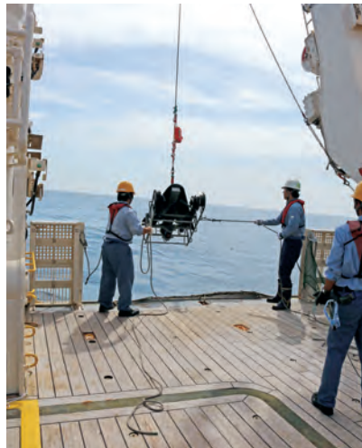
動物プランクトンの分布を調べる Video Plankton Recorder投入の様子
