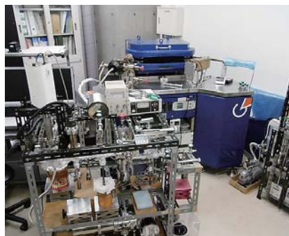
ヘリウムを分析する特殊な質量分析計。海水に溶けているヘリウムだけでなく、玄武岩ガラスや火山ガス中のヘリウムも分析することができます。
