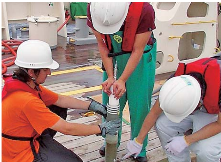
海水採取の様子。ヘリウムは逃げやすいので金属の銅管に採取して、陸上で分析するまで保管します。
