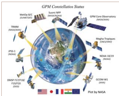
図3：GPMコンステレーション衛星。様々な国の衛星搭載マイクロ波観測を組み合わせることで全球の降水を高頻度で観測する。NASA提供。
