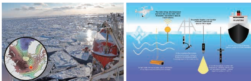
北極海の海水・海洋観測の風景（左図）と観測戦略の概略図（右図）。海水の熱力学的な成長・融解、および海水下の乱流熱輸送を捉える。
