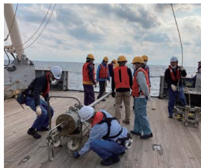
図2 ピストンコアラーを用いた海底堆積物採取 Fig. 2 Collection of seafloor sediments using core sampler
