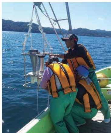
係留式セジメントトラップによる沈降物の採取 Sampling of settling materials by mooring sediment trap
