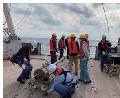
図2 ピストンコアラを用いた海底堆積物採取 Fig. 2 Collection of seafloor sediments using core sampler
