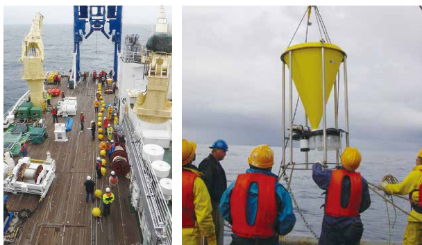
セジメントトラップ係留系設置作業風景 Installation view of sediment trap mooring system
