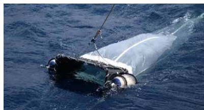
ニューストンネットを用いたマイクロプラスチックの採集 Floating microplastic sampling using a neuston net
