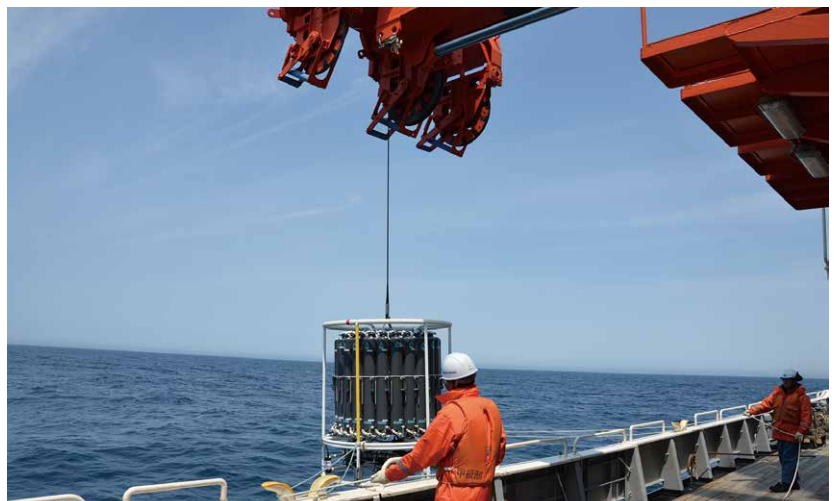
学術研究船白鳳丸による CTD 採水作業 (KH-17-3 次航海) CTD hydrocast on board R/V Hakuho Maru (KH-17-3 cruise)
