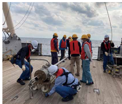
図2 ピストンコアラを用いた海底堆積物採取 Fig. 2 Collection of seafloor sediments using core sampler
