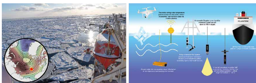
北極海の海水・海洋観測の風景（左図）と観測戦略の概略図（右図）。海水の熱力学的な成長・融解、および海水下の乱流熱輸送を捉える。
