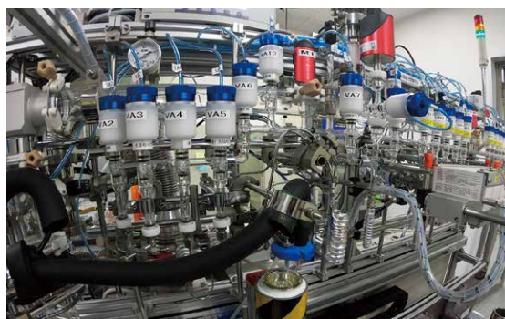
図5 高精度同位体分析のための自動化元素精製ライン Fig. 5 Automated element refining line for precise isotope analysis
