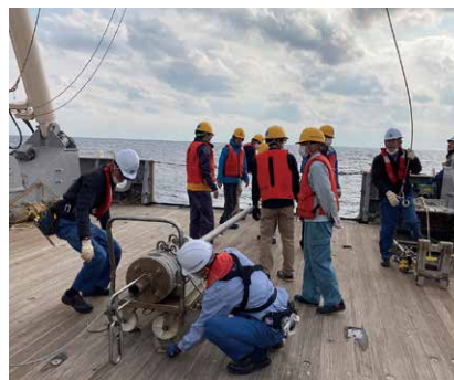
図2 ピストンコラーを用いた海底堆積物採取 Fig. 2 Collection of seafloor sediments using core sampler
