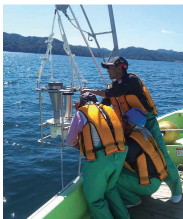
係留式セジメントトラップによる沈降物の採取 Sampling of settling materials by mooring sediment trap
