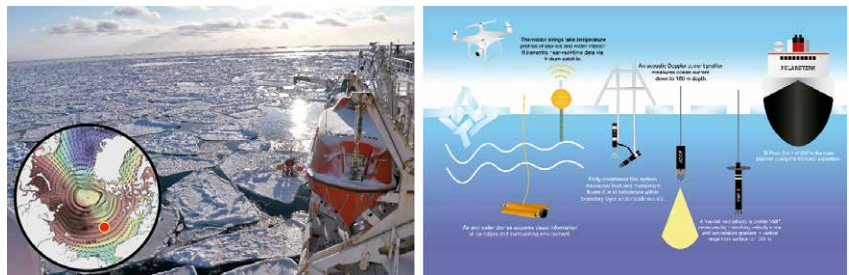
北極海の海氷・海洋観測の風景（左図）と観測戦略の概略図（右図）。海氷の熱力学的な成長・融解、および海水下の乱流熱輸送を捉える。
