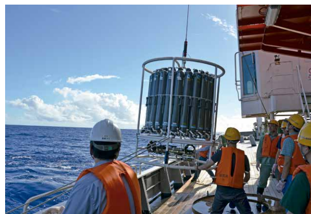
学術研究船白鳳丸によるCTDクリーン採水作業 (KH-14-6次航海) CTD clean hydrocast on board R/V Hakuho Maru (KH-14-6 cruise)
