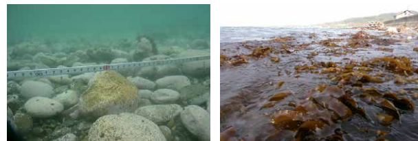
鉄を利用した藻場修復に向けた実証試験（北海道増毛町） （試験開始前の海底（左）と試験開始翌年の海域（右）） The bottom of sea (left) and sea area of field test site in Mashike-Cho, Hokkaido for the method of seaweed bed restoration by using steelmaking slag and compost
