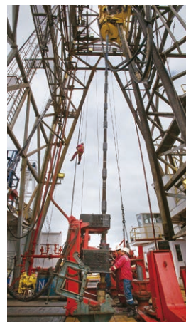
掘削船から海底に降ろされる掘削パイプ Drill pipes down into the seafloor from the drilling vessel.
