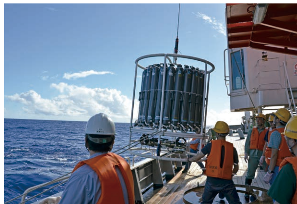
学術研究船白鳳丸によるCTDクリーン採水作業 (KH-14-6次航海) CTD clean hydrocast on board R/V Hakuho Maru (KH-14-6 cruise)
