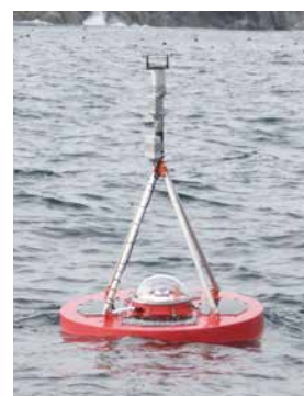
大槌湾の風と波浪のリアルタイムモニタリング Real-time monitoring of wind and wave in Otsuchi Bay
