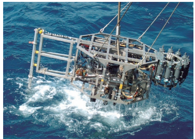
自航式深海底サンプル採取システム Navigable Sampling System (NSS)
