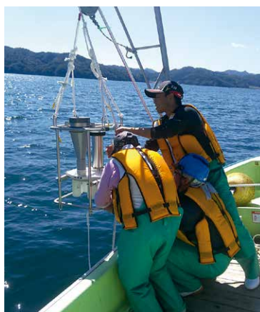
係留式セジメントラップによる沈降物の採取 Sampling of settling materials by mooring sediment trap
