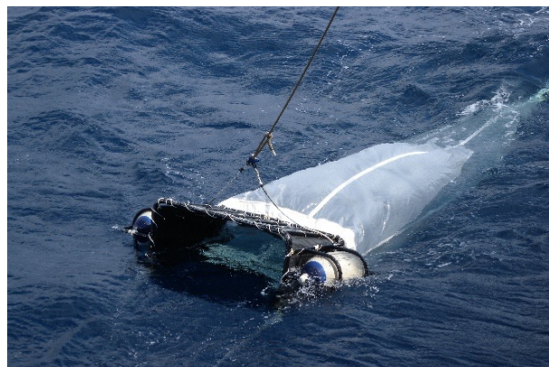
ニューズトンネットを用いたマイクロプラスチックの採集 Floating microplastic sampling using a neuston net
