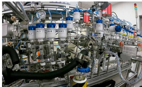
図5 高精度同位体分析のための自動化元素精製ライン Fig. 5 Automated element refining line for precise isotope analysis
