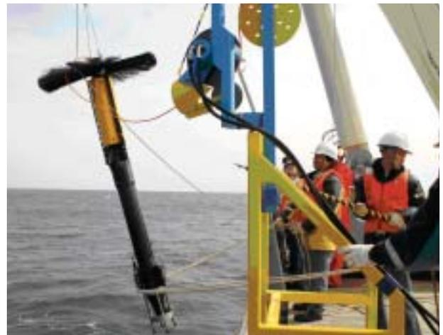
2000m深までの鉛直乱流拡散を有線で連続的に計測する
