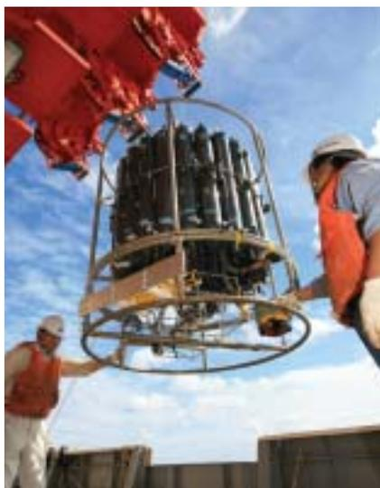
流速と水温、塩分、溶存酸素の測定
