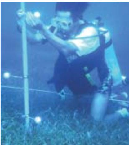
フィジーでの石膏ボールを用いた藻場の流動測定
