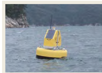
大槌湾に係留設置した水質プロファイリングブイ。ブイで計測しているデータは同時に設置した波浪ブイのデータとあわせてインターネットでリアルタイムに公開する予定。
