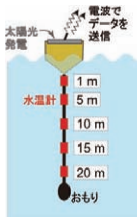
水温観測装置のしくみ
