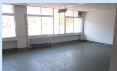
瓦礫の撤去が終了したセンター3階の共同利用研究員室。震災直後は什器類が入り口を塞いだ状態だったが、これらは撤去され、清潔な状態に復旧した。割れた窓ガラスも新しいものに交換され、精密機器類の保管も可能になっている。
