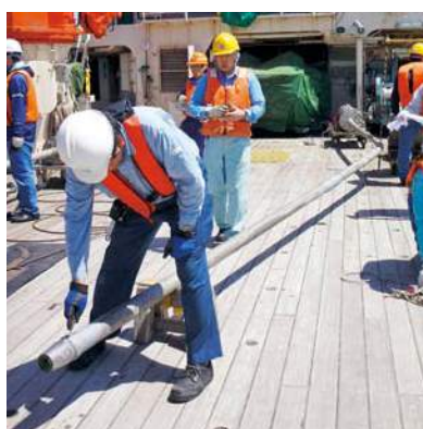
大きく曲がったピストンコアラーのパイプ
