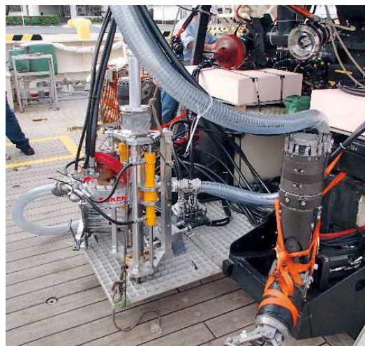
無人探査機「ハイパードルフィン」に搭載されたドリル装置
