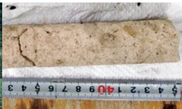
採取時の向きを示すラインの付いた岩石の採取に成功
