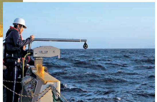
アンダーウェイCTDによる観測。ケーブルの先端には多項目センサー（塩分、水温、水深、クロロフィル濃度、酸素濃度、濁度などを測定する装置）が装着されている。これを、船の航行中に、特殊なウインチを使って頻繁に上げ下げすることで、海水中の物理環境や生物地球化学的な状態についてのデータを、高頻度で得ることができる（撮影：坂本 天）
