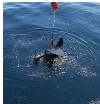
動物プランクトンの分布を調べるVideo Plankton Recorder投入の様子
