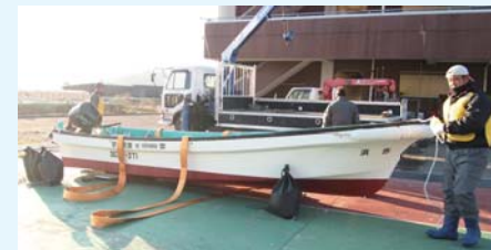
図3 新調査船「赤浜」 ◎船質:FRP ◎総トン数:1.21トン ◎船舶の長さ、幅、深さ:5.75m x 1.55m x 0.62m ◎定員:5名 ◎船外機(エンジン):30kw馬力(スズキ製4ストローク)
