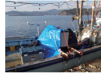
図2 サイドスキャンソナーを用いた船による調査
