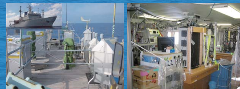
W-PASS参加者が多数乗船した学術研究船白鳳丸KH-08-2次航海から (左) 大気エアロゾルサンプラーやエアロゾル測定装置を満載したアッパーデッキ (右) 大気エアロゾル観測装置が狭狭と設置された白鳳丸内の第1研究室
