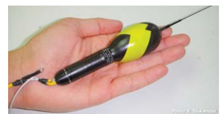
ポップアップタグ。親ウナギの産卵回遊中の遊泳水深と水温を記録して海面に浮上し、人工衛星経由でデータを地上に送ってくる。
