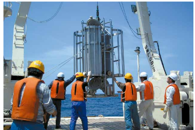
研究船淡青丸における大量採水器を用いた観測作業（日本海にて） Large volume water sampling on board R/V Tansai Maru (Japan Sea)
