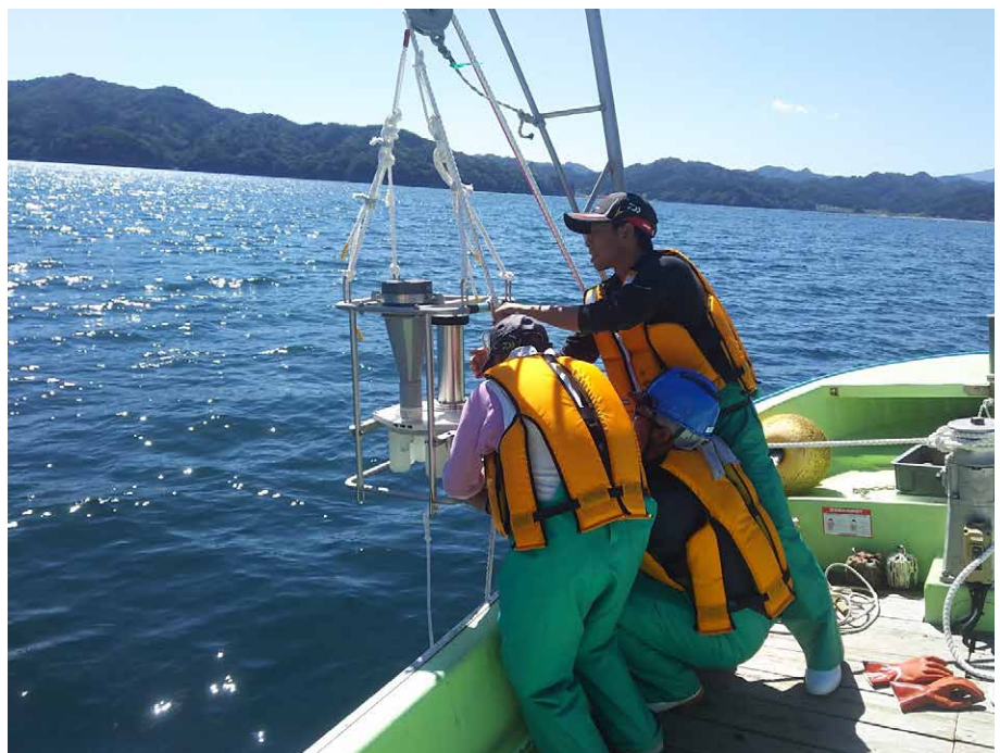
係留式セジメントラップによる沈降物の採取 Sampling of settling materials by mooring sediment trap
