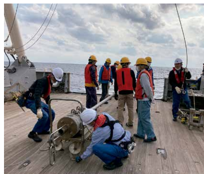
図2 ピストンコーラーを用いた海底堆積物採取 Fig. 2 Collection of seafloor sediments using core sampler
